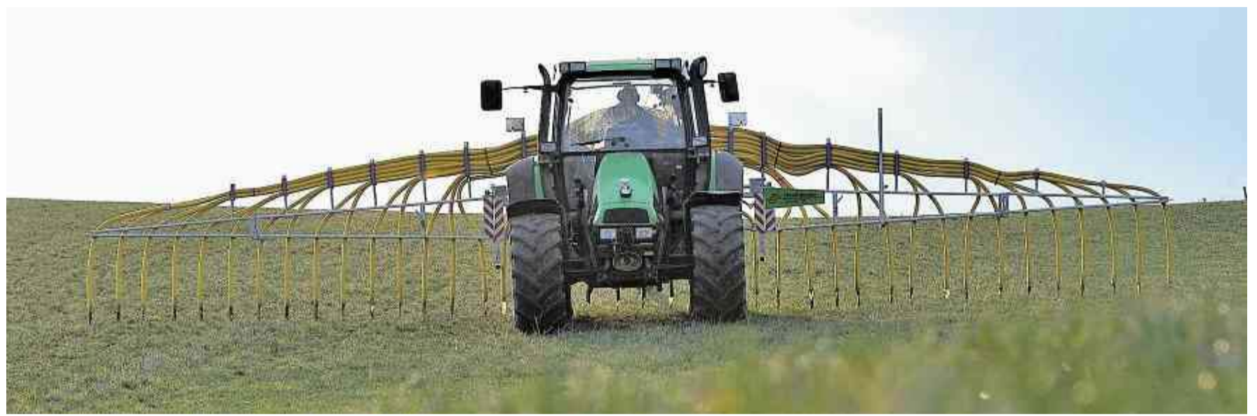
Eine Schleppschlauch-Düngung bei Warth: Mittlerweile werden 47 Prozent der Thurgauer Gülle auf diese Art ausgebracht.
